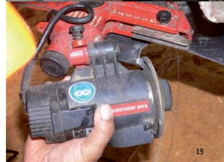
b. Verificar el afilado del disco: Diariamente, el operador del aserradero tiene que afilar el disco antes de iniciar el trabajo. Si el disco no está bien afilado se obtendrá un mal corte y puede provocar la rotura de las pastillas. En general, es recomendable afilar el disco después de cada 300 pies de madera dura aserrada o 500 pies de madera blanda aserrada.
